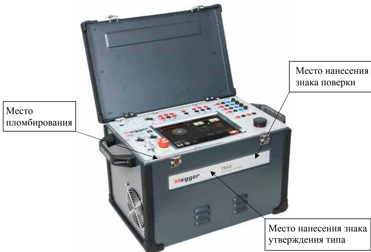
Рисунок 1 - Общий вид системы TRAX 220, схема пломбировки от несанкционированного доступа, обозначение мест нанесения знаков утверждения типа и поверки
