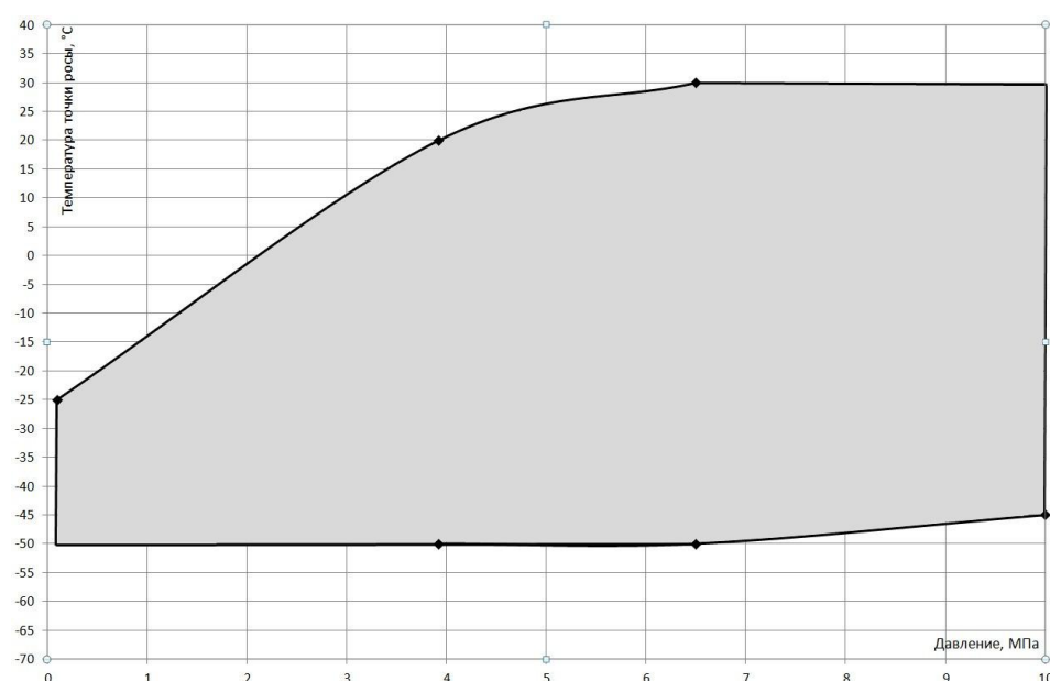
Рисунок 2 - Зависимость диапазона измерения точки росы от давления исследуемого газа
