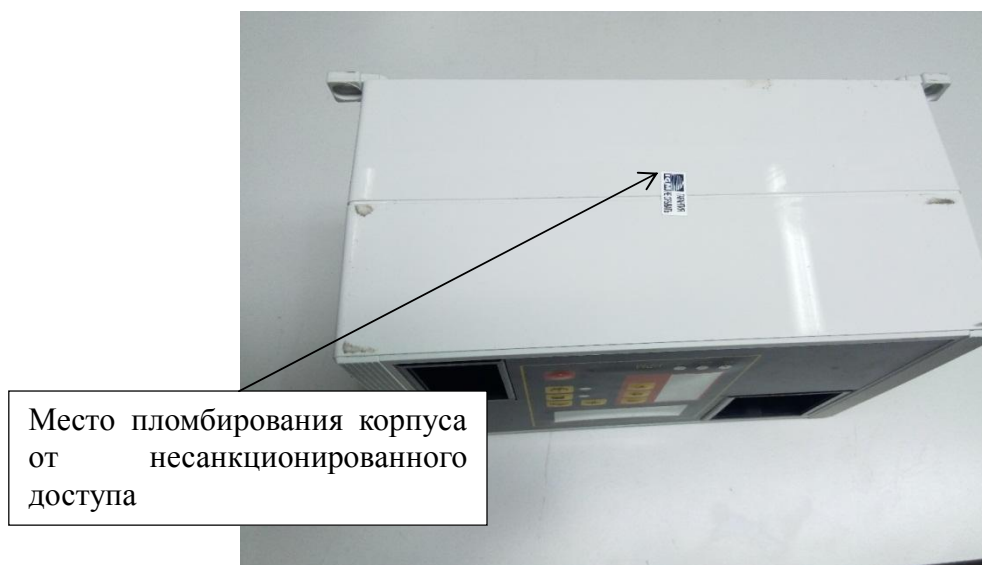
Рисунок 2 – Схема пломбирования газоанализаторов от несанкционированного доступа (модель 1011)
