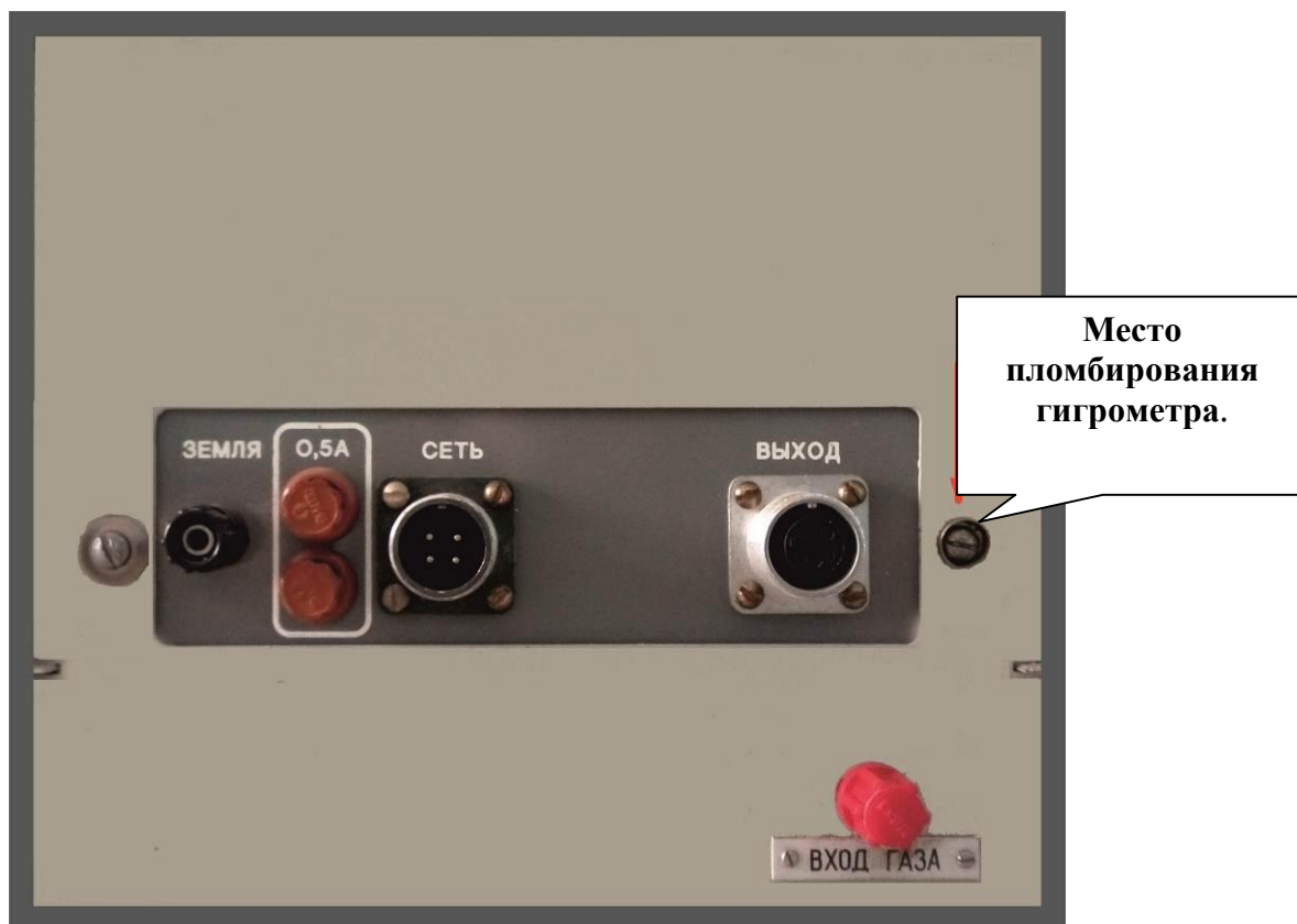
Рисунок 2 - Задняя панель гигрометра БАЙКАЛ-5Ц
