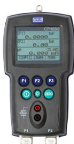
Рисунок 2 – Общий вид калибраторов CPN6200-S1, CPN6200-S2
