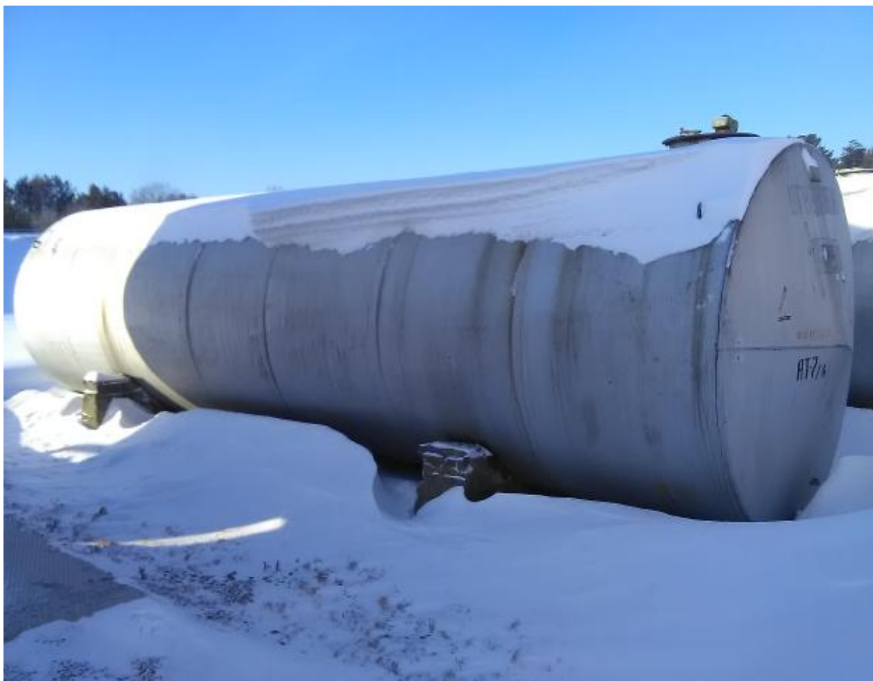
Рисунок 1 - Общий вид резервуара стального горизонтального цилиндрического РГС-60
