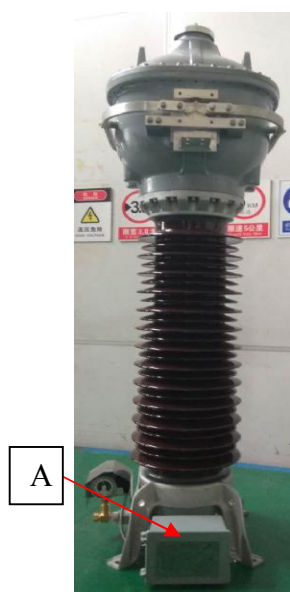
а) трансформаторы тока LVQB-35, LVQB-110
