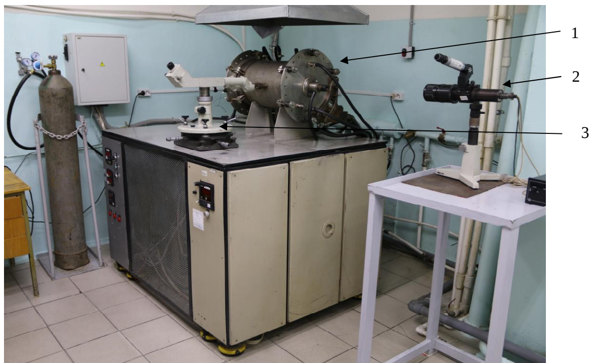
Рисунок 1 – Общий вид дилатометра ВД-1 № 001 1 – ЭВП, 2 – пирометр прецизионный ПД-4, 3 – горизонтальный микроскоп типа МГ-2
