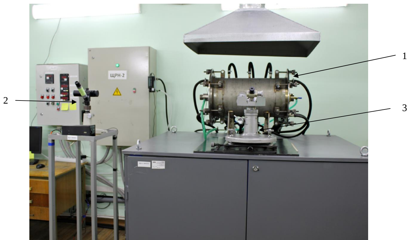
Рисунок 2 – Общий вид дилатометра ВД-1 № 002 1 – ЭВП, 2 – пирометр прецизионный ПД-4, 3 – горизонтальный микроскоп типа МГ-1
