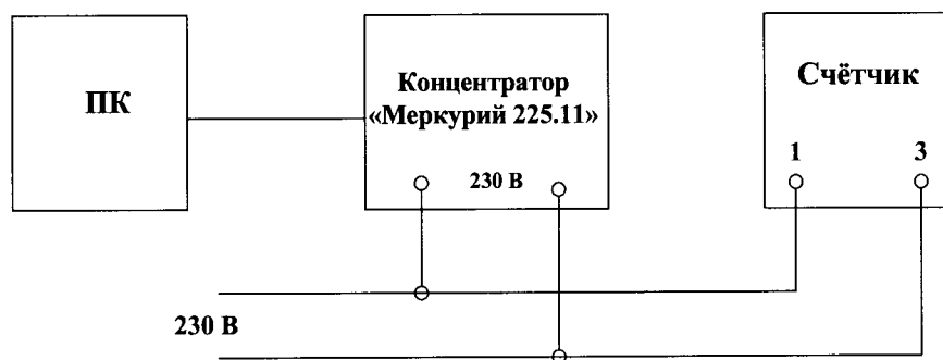
Рисунок А.1 - Схема для проверки функционирования PLC-модема
