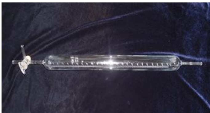
Рисунок 1 - Общий вид бюреток кальциметра вместимостью 250 мл 2 класса точности
