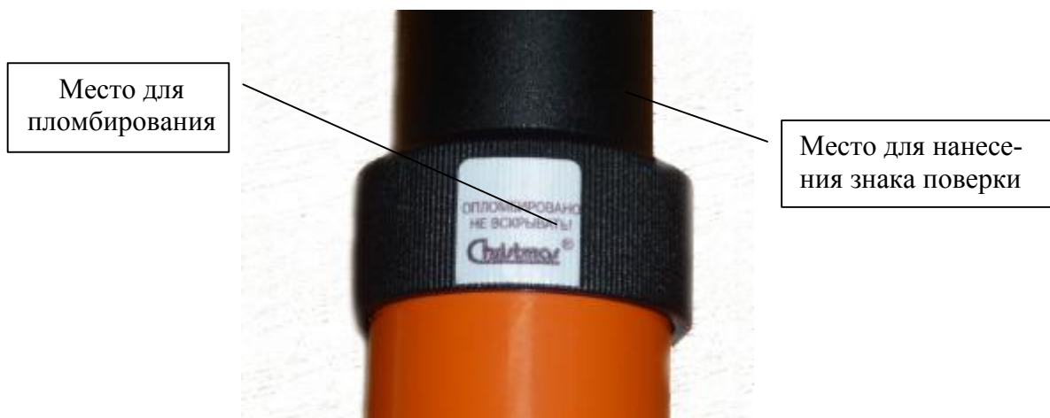
Рисунок 2 – Схема пломбировки и места нанесения знака поверки
