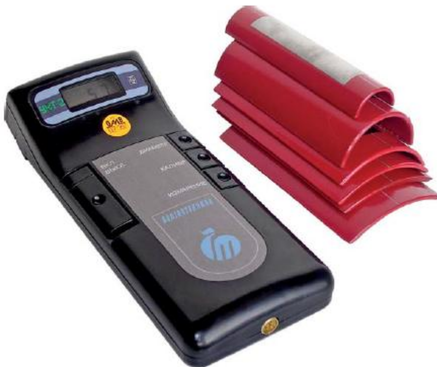
Рисунок 1 – Общий вид устройств контроля толщины изоляции УКТ-2
