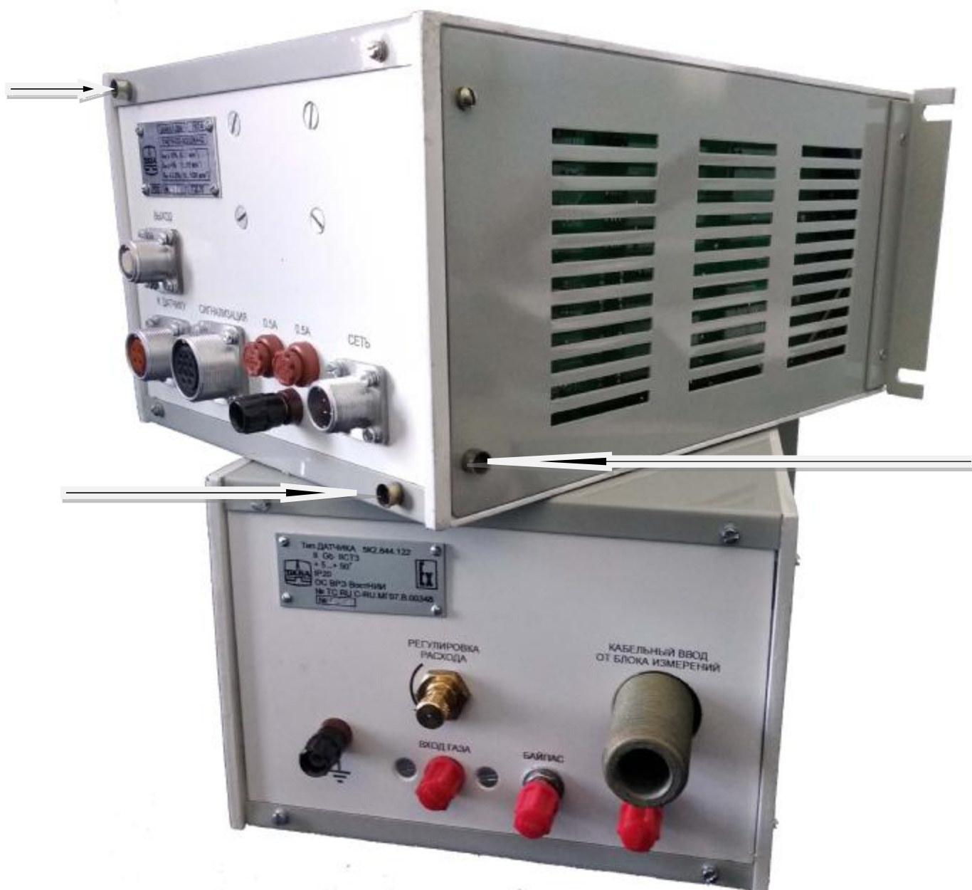
Рисунок 2 – Схема пломбировки от несанкционированного доступа гигрометра кулонометрического БАЙКАЛ-2ВМ
