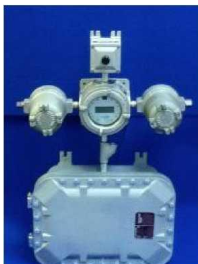
Рисунок 3 – Общий вид интерфейсного модуля E/TGI-EX
