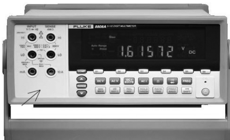
Рисунок 1 - Внешний вид мультиметра цифрового Fluke 8808A. Стрелкой показано место нанесения знака утверждения типа.
