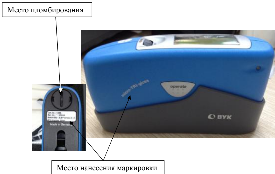
Рисунок 1 – Общий вид блескомеров micro-gloss и места пломбирования и нанесения маркировки
