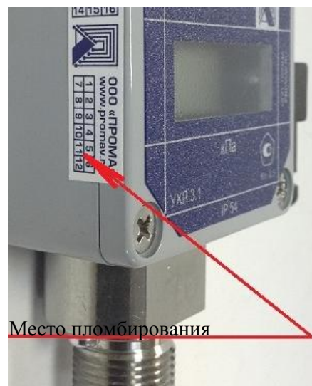
Рисунок 2 - Места пломбирования датчиков
