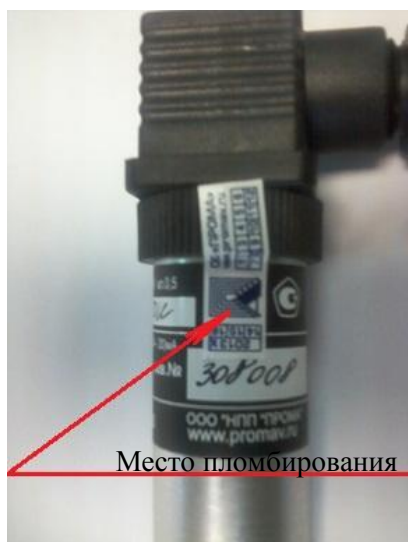
Рисунок 2 - Места пломбирования датчиков
