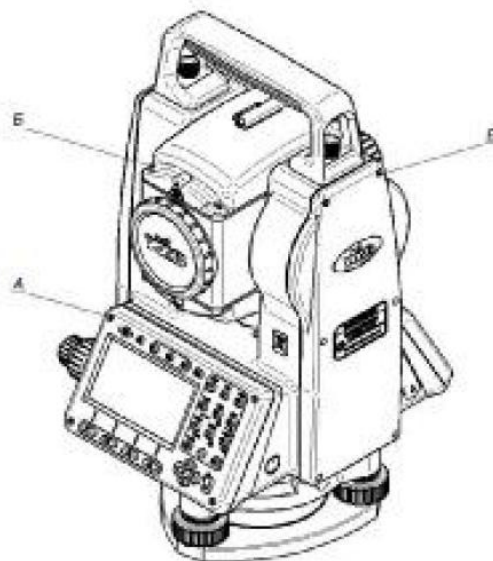
Рисунок 1 – Схема пломбирования тахеометров электронных 6Та3 от несанкционированного доступа
