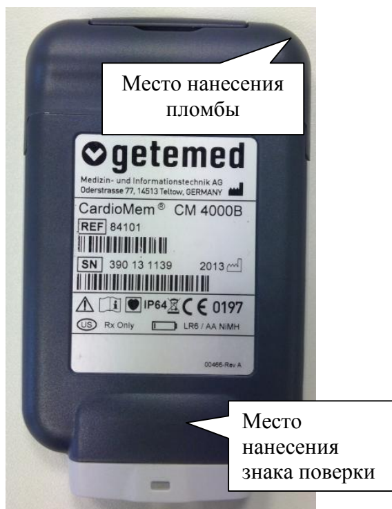
Рисунок 2 – Схема пломбировки от несанкционированного доступа, обозначение места нанесения знака поверки
