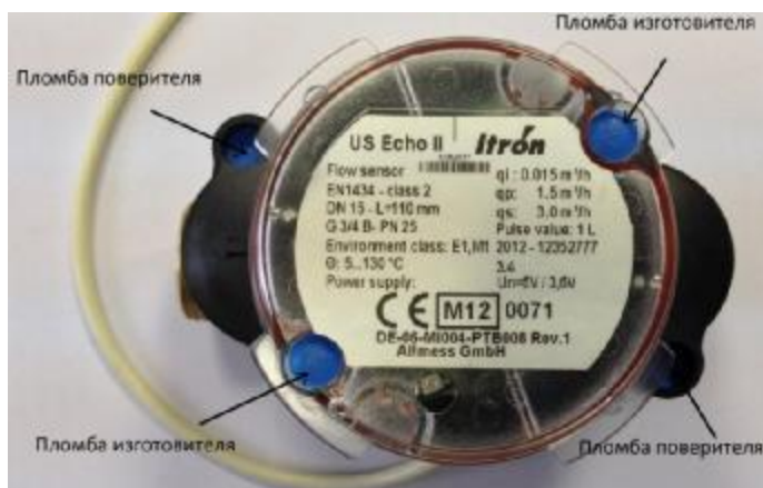
Рис. 3 - Места пломбировки расходомера US Echo II
