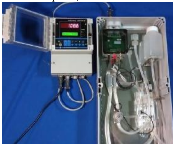
Рис.2. Блок контроллера с датчиком рН.
