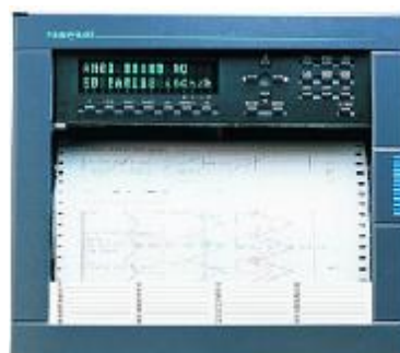
Рисунок 6 - Фотография общего вида прибора DPR250
