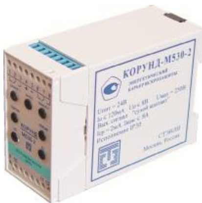
Рисунок 12 – Общий вид барьера КОРУНД -М530-2 (двухканальный)
