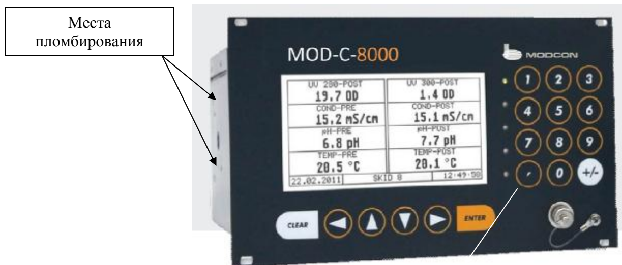
Рисунок 2 – Общий вид универсальных преобразователей MOD-C-8XXX с указанием мест пломбирования
