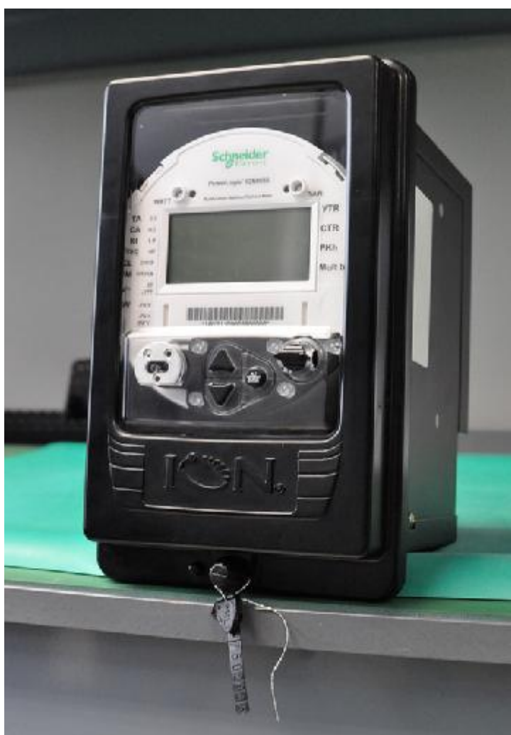
Рис.3. Место пломбирования щитового корпуса счетчика ION8650
