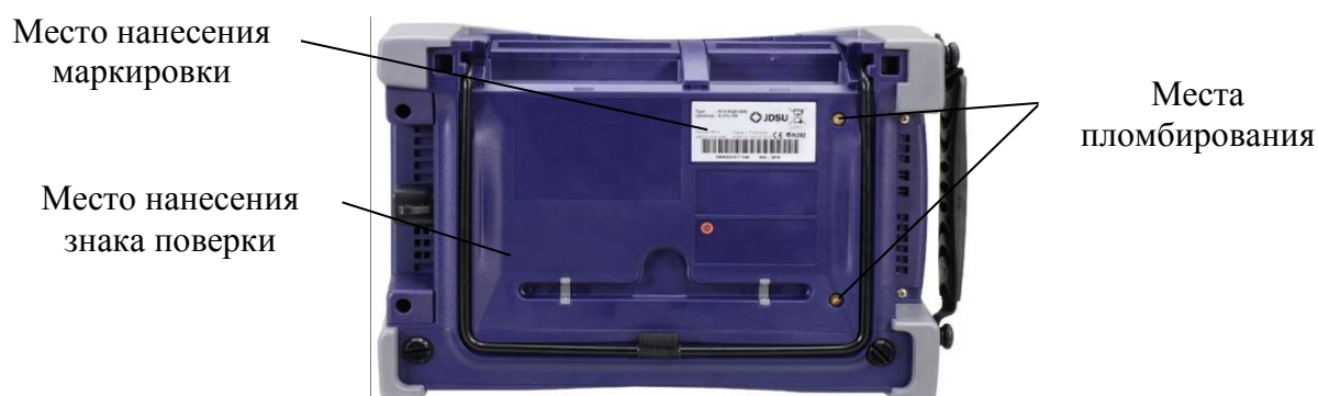
Рисунок 3 – Схема пломбировки от несанкционированного доступа, обозначение места нанесения знака поверки базового блока модификаций MTS-6000, MTS-6000A
