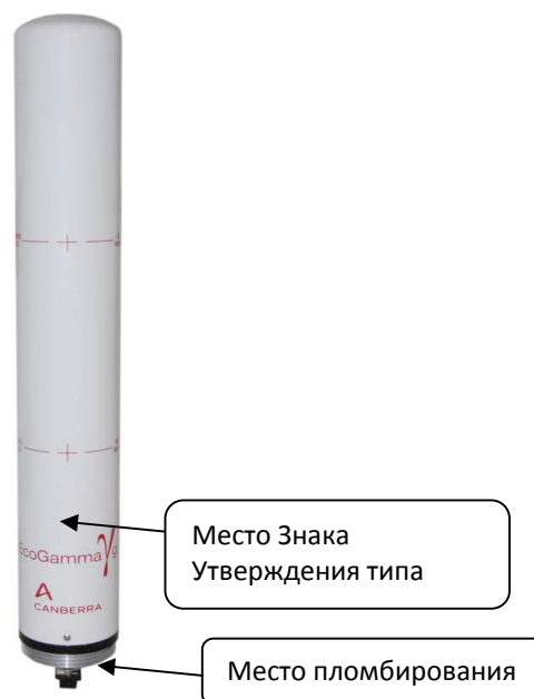
Рисунок 1 - Общий вид измерителя мощности дозы EcoGamma-g
