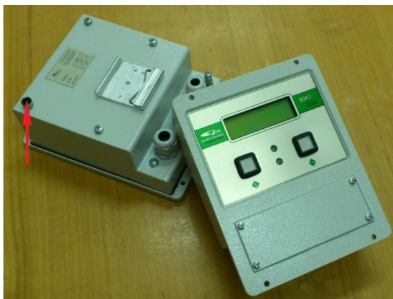
Рисунок 12 – Схема пломбировки от несанкционированного доступа блока БОИ-4
