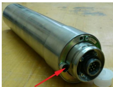
Рисунок 10 – Схема пломбировки от несанкционированного доступа блоков БД-6-1, БД-6-1Д, БД-6-5, БД-6-5Д
