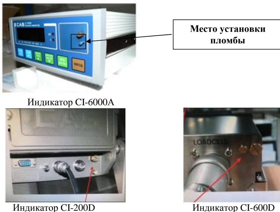
Рисунок 2 – Схемы пломбирования индикаторов
