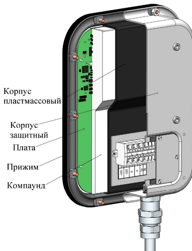
Рисунок 6 – Схема пломбировки от несанкционированного доступа
