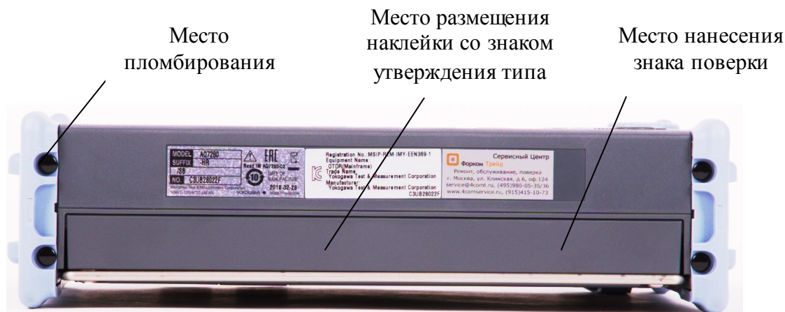
Рисунок 2 – Нижняя сторона рефлектометров со схемой пломбировки от несанкционированного доступа и местом нанесения знаков утверждения типа и поверки
