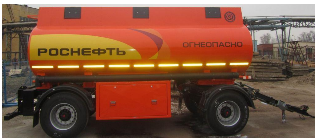
Рисунок 5 - Общий вид прицепа-цистерны БЦМ-230 модель 86413-0000010
