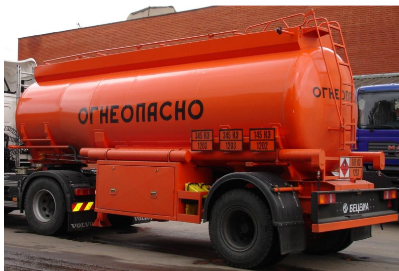
Рисунок 4 - Общий вид полуприцепа-топливозаправщика БЦМ-48 модель 96054-0000010
