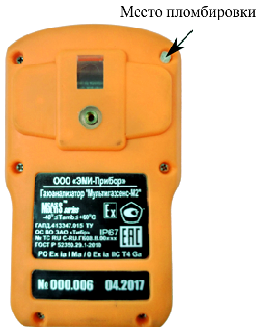
Рисунок 2 – Схема пломбировки от несанкционированного доступа МУЛЬТИГАЗСЕНС-М2
