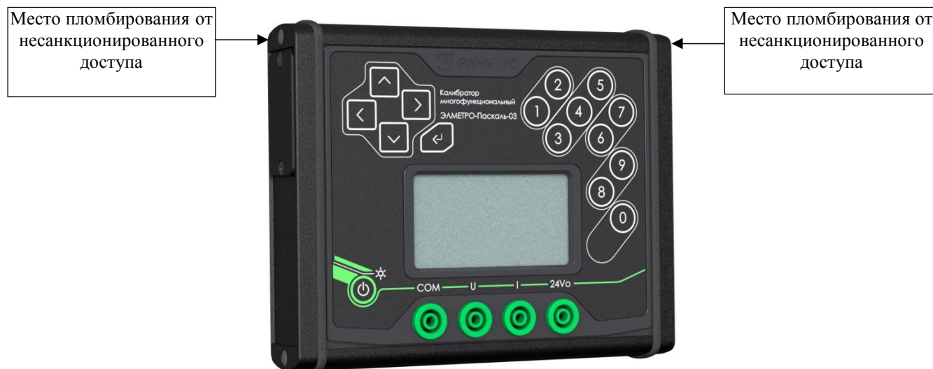
Рисунок 1 – Общий вид калибраторов и место пломбирования от несанкционированного доступа
