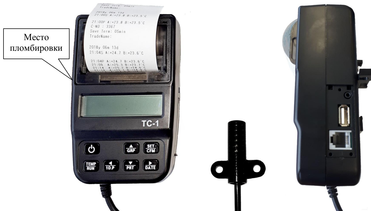
Рисунок 1 – Общий вид термоконтроллеров ТС-1 и схема пломбировки от несанкционированного доступа
