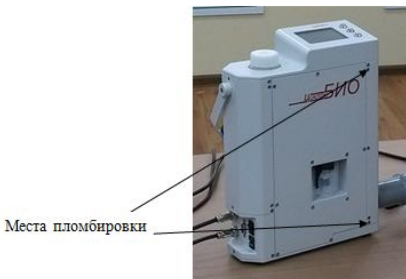
Рисунок 2 - Схема пломбировки пробоотборника аэрозольного «Циклон-БИО» от несанкционированного доступа
