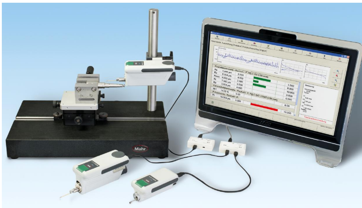
Рисунок 5 – Общий вид приборов для измерений параметров шероховатости поверхности MarSurf XR1
