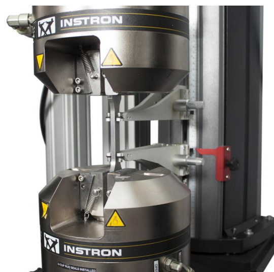
Рисунок 2 – Рабочая зона датчиков перемещений (деформаций) AUTOX 750
