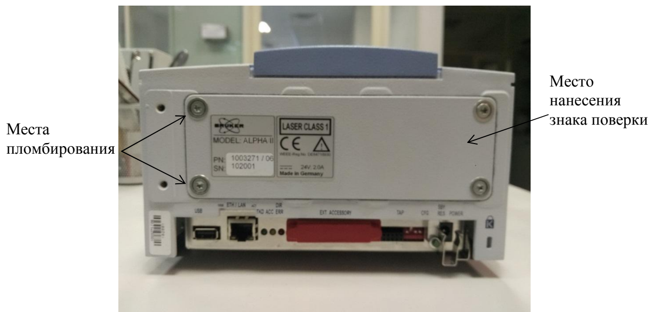
Рисунок 2 – Обозначение места нанесения знака поверки, схема пломбировки от несанкционированного доступа
