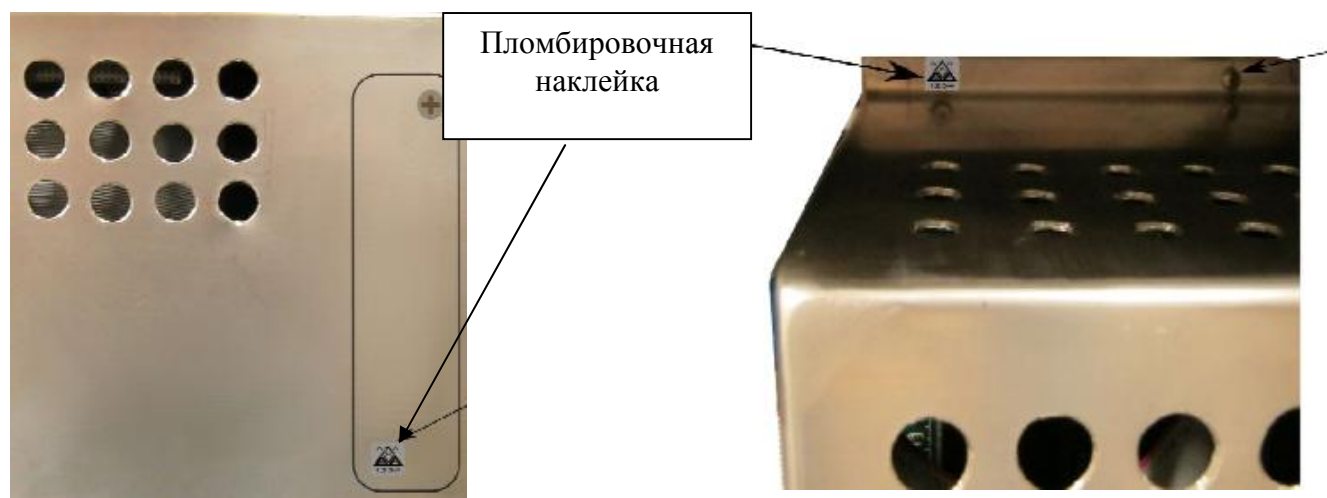
Рисунок 6 - Схема пломбировки печатной платы электронного устройства обработки измерительной информации и управления
