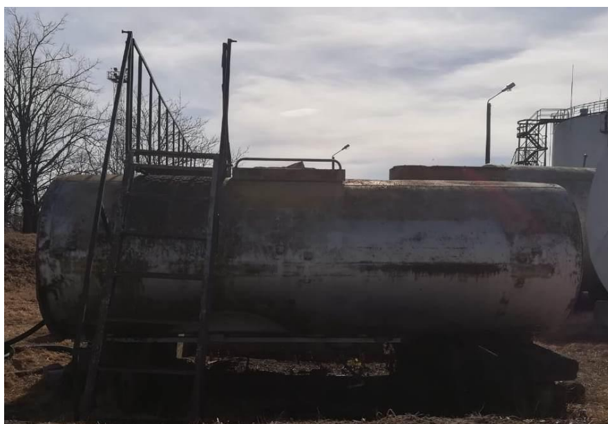
Рисунок 4 - Общий вид резервуара стального горизонтального цилиндрического РГС-10
