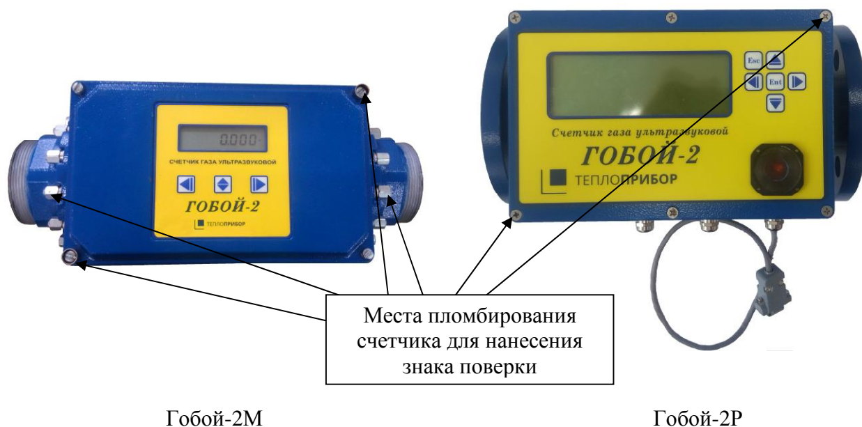
Рисунок 1 – Общий вид счетчиков и места пломбирования для нанесения знака поверки
