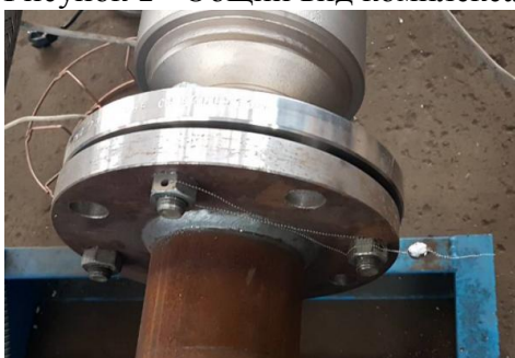
Рисунок 3 - Пломба поверителя, препятствующая демонтажу СРМ
