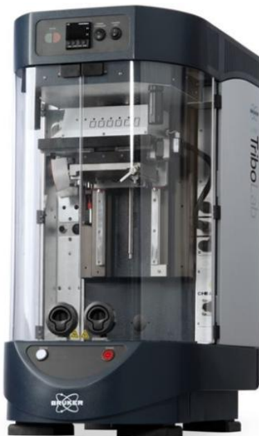
Рисунок 1 - Общий вид системы для механических испытаний универсальной UMT TriboLab
