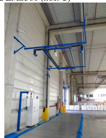
Рисунок 1 - Общий вид комплексов для измерений габаритных размеров APACHE p8 LFT (поз. А), шкафа управления (поз. В) и лазерного сканера LMS500 (поз. С)
