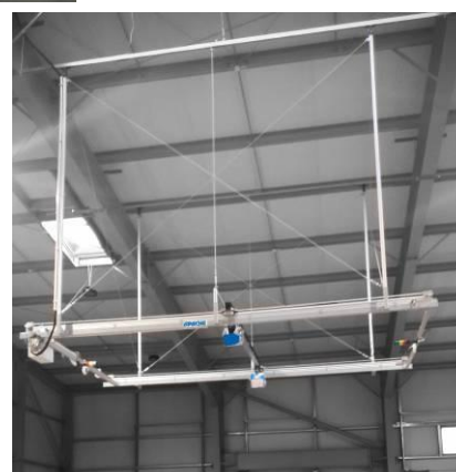
Рисунок 2 – Примеры конструктивного размещения несущей рамы со специальной балкой и рельсовыми направляющими с электроприводом
