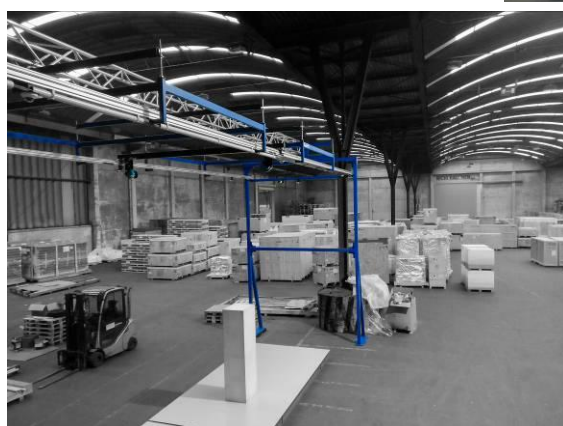
Рисунок 2 – Примеры конструктивного размещения несущей рамы со специальной балкой и рельсовыми направляющими с электроприводом
