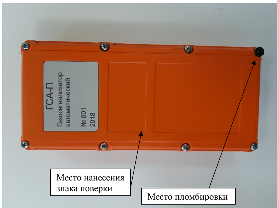
Рисунок 2 – Схема пломбировки от несанкционированного доступа, обозначение места нанесения знака поверки
