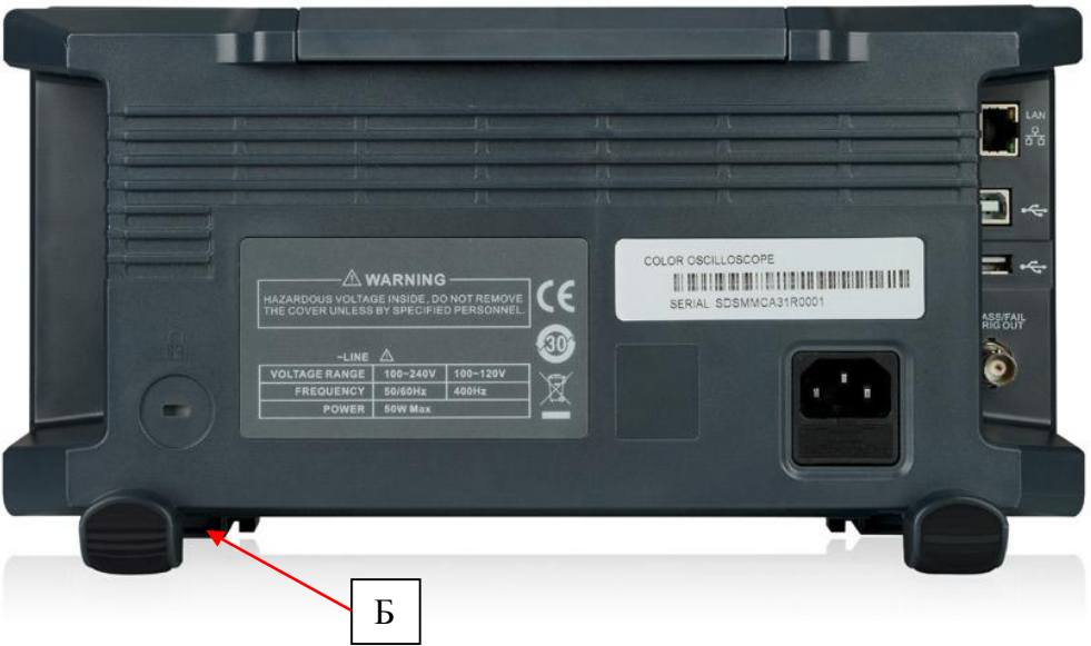
Рисунок 2 – Схема пломбировки от несанкционированного доступа (Б)
