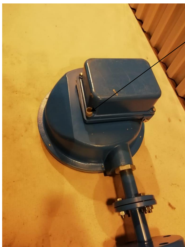
Рисунок 2 – Вид сзади уровнемеров с местом пломбировки от несанкционированного доступа
