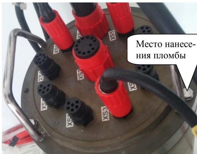
Рисунок 2 – Схема пломбировки от несанкционированного доступа
