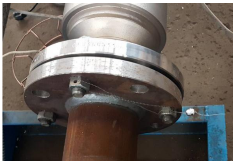
Рисунок 3 - Пломба поверителя, препятствующая демонтажу СРМ
